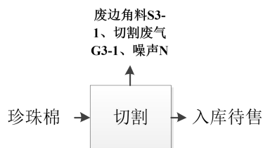
图 2-5 珍珠棉制品生产工艺及产污节点图
