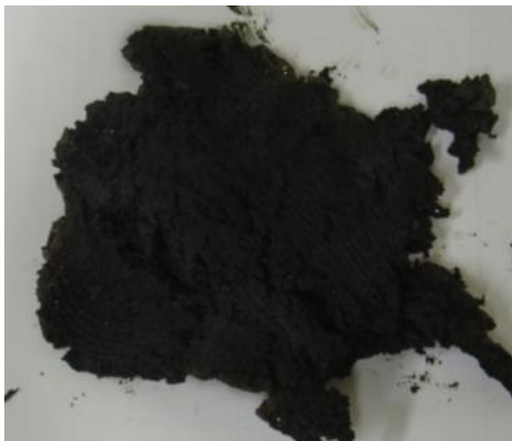
未使用全过程生物除臭工艺的脱水污泥
