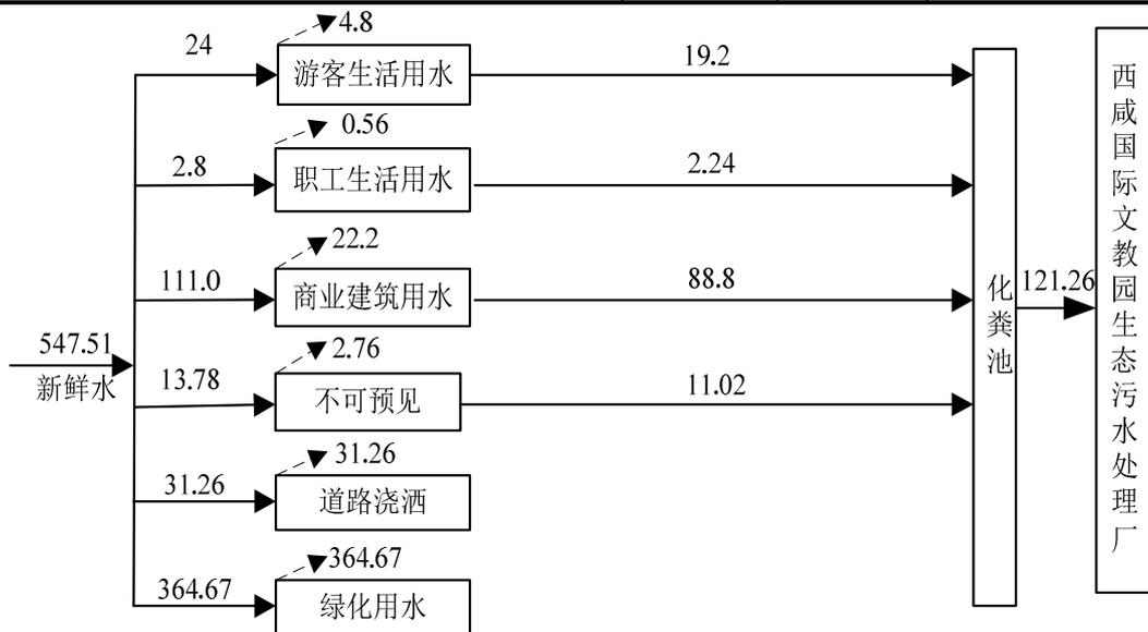
图 5-3 项目运营期水平衡图 单位：m<sup>3</sup>/d
