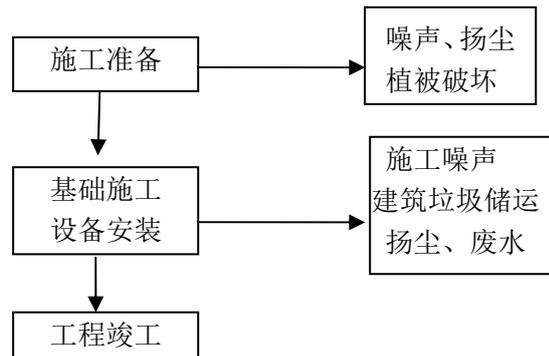
图 8 变电站工程建设期工艺流程及环境影响示意图
