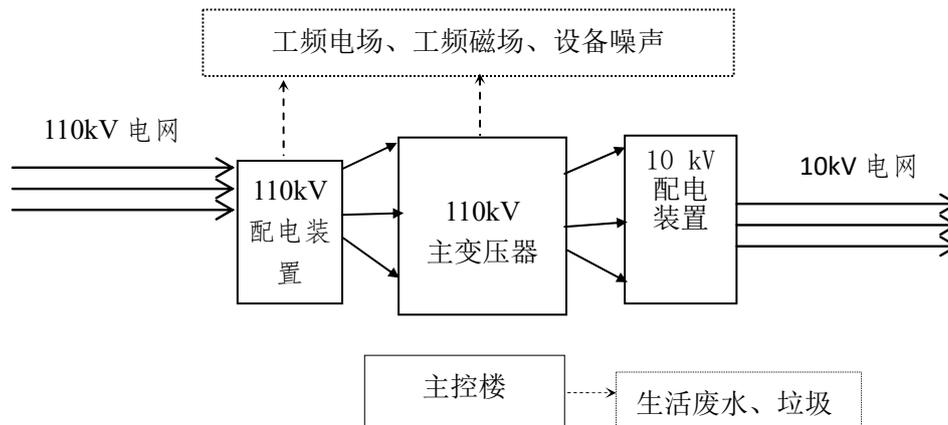
图 9 变电站工程运行期工艺流程及环境影响示意图
